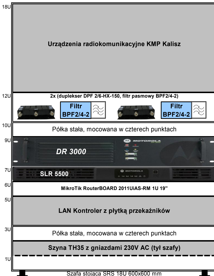
Rysunek 7 Szafa teletechniczna – przykładowe uкомплекowanie – SLR Kalisz/Chełmce
